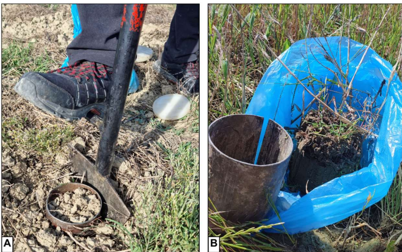
Fig. 3 - A) Carotatore con volume di circa 1000 cm 3 utilizzato per il campionamento di suolo per determinare l'indice QBS-ar. B) Per il trasporto, ogni sottocampione raccolto viene posto in un sacchetto di plastica.
